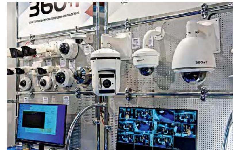
РАЗРАБОТАННЫЕ НАУЧНО-ИССЛЕДОВАТЕЛЬСКИМ ЦЕНТРОМ «ТЕХНОЛОГИИ» КАМЕРЫ ВИДЕОНАБЛЮДЕНИЯ СПОСОБНЫ РАБОТАТЬ ДАЖЕ ПРИ ТЕМПЕРАТУРЕ МИНУС 60 ГРАДУСОВ ПО ЦЕЛЬСИУ
