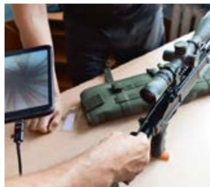
ПО ЗАВЕРШЕНИИ ЧИСТКИ ОРУЖИЯ НЕОБХОДИМО ПРОВЕРИТЬ СОСТОЯНИЕ СТВОЛА ПРИ ПОМОЩИ БОРОСКОПА
